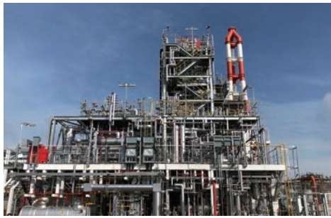
環境に配慮したエタノール由来のエチレン試験製造設備
